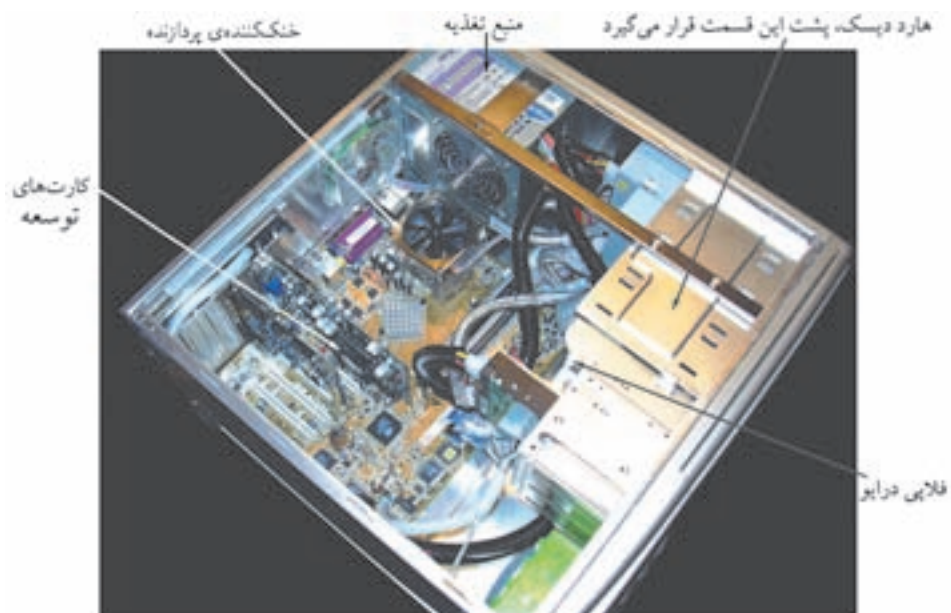
شکل ۱۸-۴ اجزای داخلی یک Case رایانه
