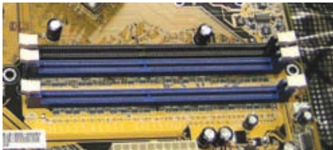
شکل ۳ محل قرار گرفتن RAM روی برد اصلی
